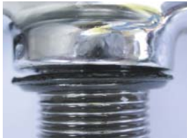
So sieht ein falsch dimensionierter O-Ring nach der Demontage aus.
