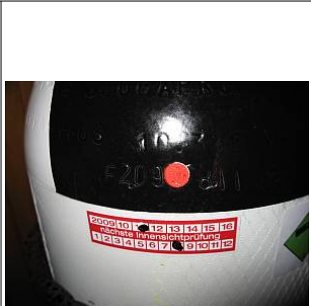
Flaschenschulter lackiert und TÜV-Stempel hervorgehoben
