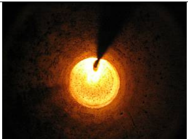
Flasche von merlin nach TÜV bei Fa. Ca**** in D Diese Flasche habe ich gleich nach dem TÜV in meiner Werkstatt geöffnet - das Ergebnis war erschreckend, bröseliger Rost - obwohl die Flasche auf telefonische Nachfrage als "innen im guten Zustand" bezeichnet wurde.
